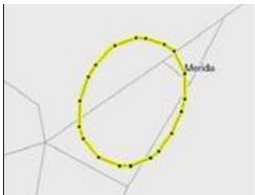
Figura 13. Track con tiempo de 1 segundo de adquisición de puntos
